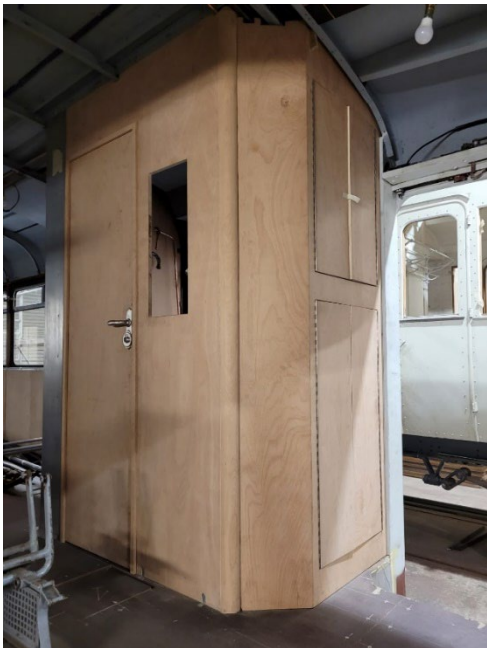
Le cabinet WC avec les armoires électriques a été renouvelé et ajusté à sa place (décembre 2023)
