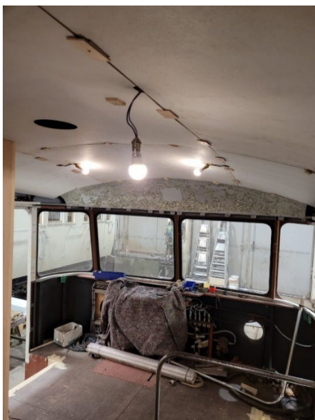
Le faux plafond renouvelé est mis en place après réfection du câblage pour lumière, ventilation et sonorisation (février 2024)
