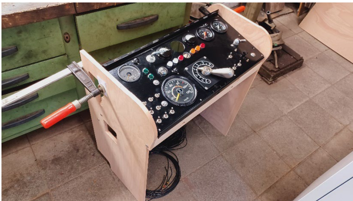
Montage à blanc des tableaux de bord renouvelés et précablés dans leur nouveau meuble (août 2022)
