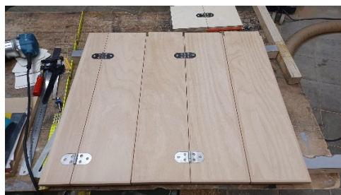
Détails du renouvellement des volets et des portes pliantes aux postes de conduite (août 2022)
